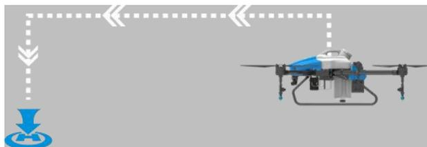
返航流程：进入返航——飞机上升至设置的返航高度——飞机以最大 8m/s 的速度飞向返航点——到达返航点——调整飞机位置——下降高度——降落并上锁。
