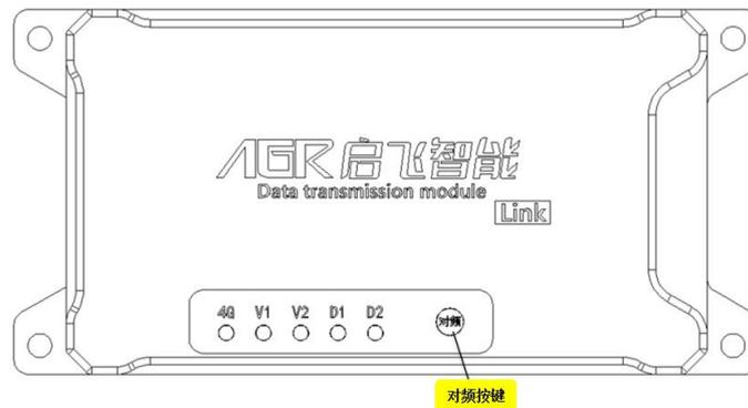
**对频说明：**当遥控器和飞机断开信号连接时；当更换遥控器或者数链时；当遥控器对飞机操作无反应时；当采用升级线对飞控升级后；均需要进行对频操作后遥控器才可以控制飞机。
