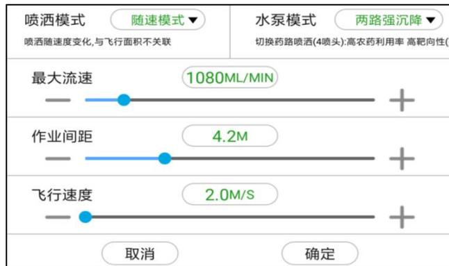
开始作业前可以设置喷洒模式、水泵模式、作业间距以及飞行速度。
