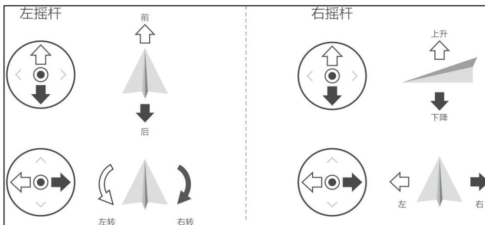
美国手：左摇杆控制飞机上升、下降、左转、右转，右摇杆控制飞机前行、后退、左移、右移。
