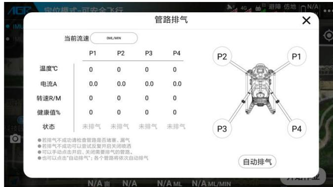
飞机未起飞前，可以直接点击遥控器喷洒按钮或者在 APP 进入管路排气开启喷洒进行喷洒排气。
