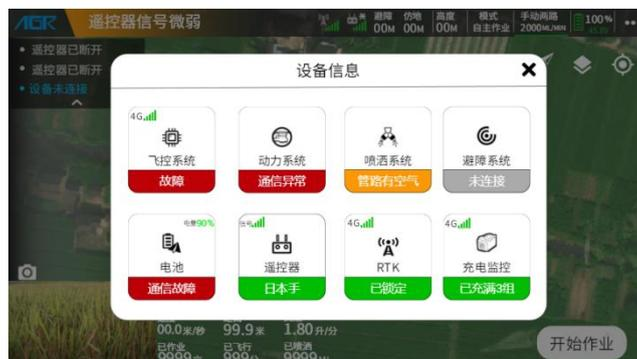
④定位状态：
