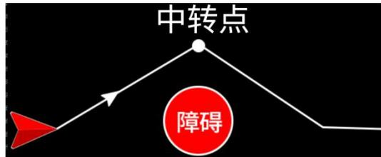
支持添加一个起飞/返航中转点，起飞中转点高度和起飞高度一致，返航中转点和返航高度一致。
