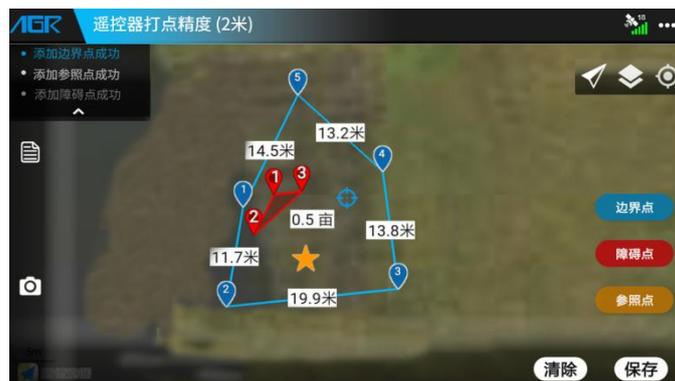
请根据状态栏颜色和遥控器精度提示打点，以保障作业安全：
