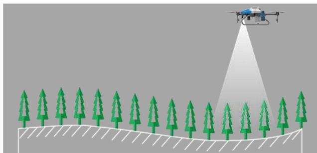
飞机凭借仿地雷达，可以按照设定高度始终与作物保持一定高度作业。即飞机跟随地形起伏变化而调整飞行高度。
