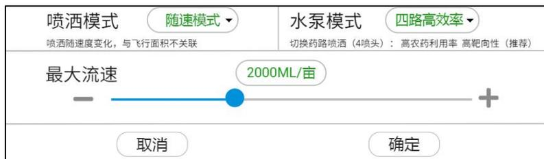
飞行的高度、速度与遥控器手动操作杆量有关，实际流速与设定的喷洒模式、水泵模式有关。
