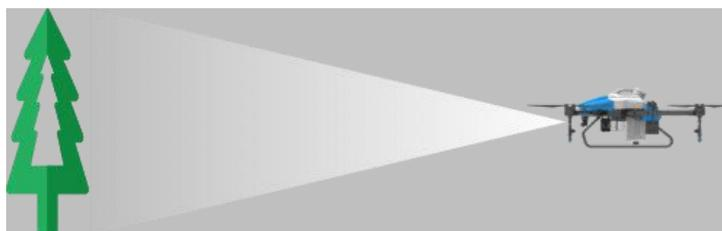
在飞机识别障碍物——减速——悬停过程中，用户可以操作飞机远离障碍物，但是无法操作飞机靠近障碍物。
