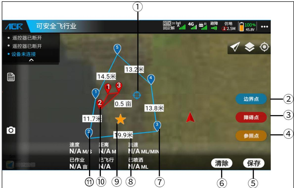
①打点定位图标
