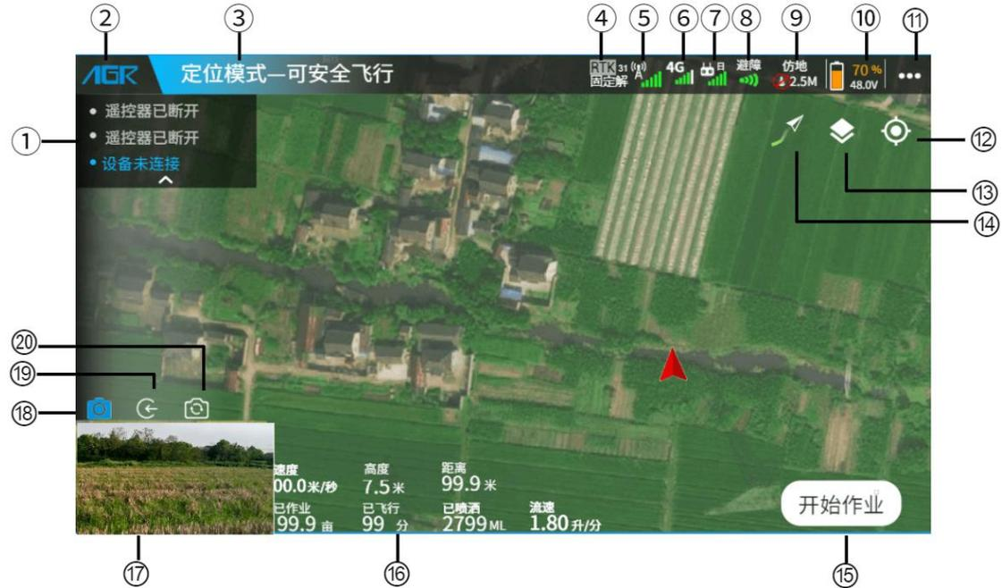
①信息提示框：显示飞行器状态提示信息，展开时点击底部 $\wedge$ 可以上拉收起提示框，收起时点击顶部 $\nabla$ 下拉展开提示框。上下滑动提示框内信息可以查看更多历史提示信息。
